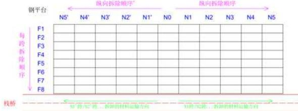
图 1 钢平台拆除顺序示意图
