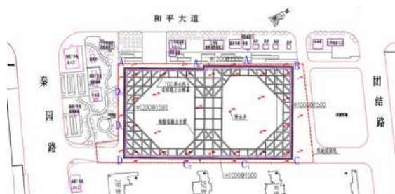
图 1 新建项目基坑支护平面图
