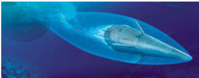
图1 空化汽泡包络的鱼雷
