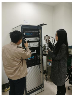
图4 天津大学硕士生在联合培养中心进行宽频介电抗谱测量
