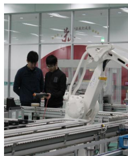
图 3 天津大学学生在培养基地进行单相电能表自动检定
