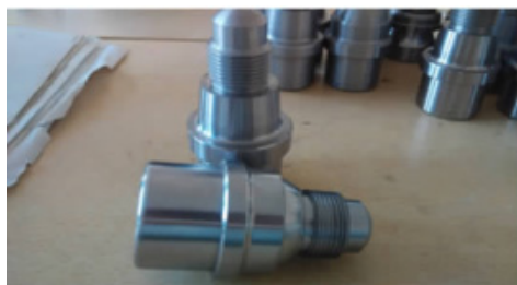
图3 轴类零件加工范例
