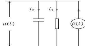
设电容  $C$  上原来电压为 0， $\mu(0)=0$ ，求电压  $\mu(t)$
