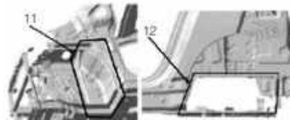
图4 立体环形结构与隐式环形结构
