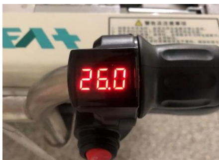
图 5：新电池安装后把手上电压显示
