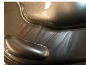
图 2 板件冲压成形缺陷-起皱
