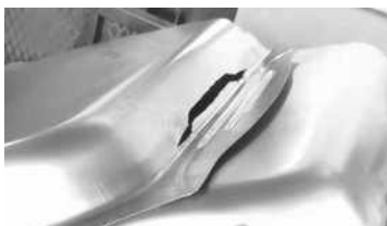
图4 板件冲压成形缺陷-拉裂
