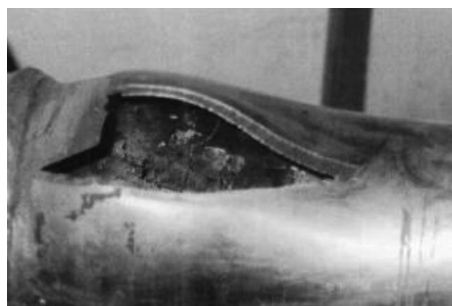
图1 压力容器韧性破裂
