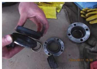
图3 密封波纹管腐蚀现象
