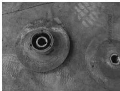
图2 叶轮腐蚀情况
