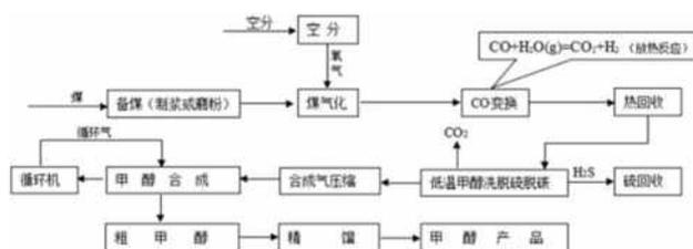
图1 煤化工工艺路线图
