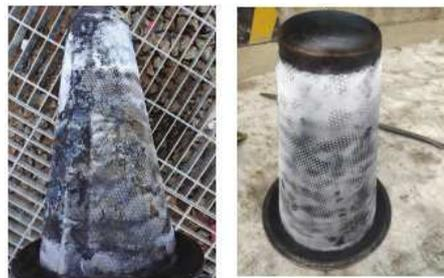
图一 保护过滤器第一次清理和最后一次清理对比图
