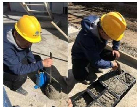
图一: 混凝土现场抽样检测
